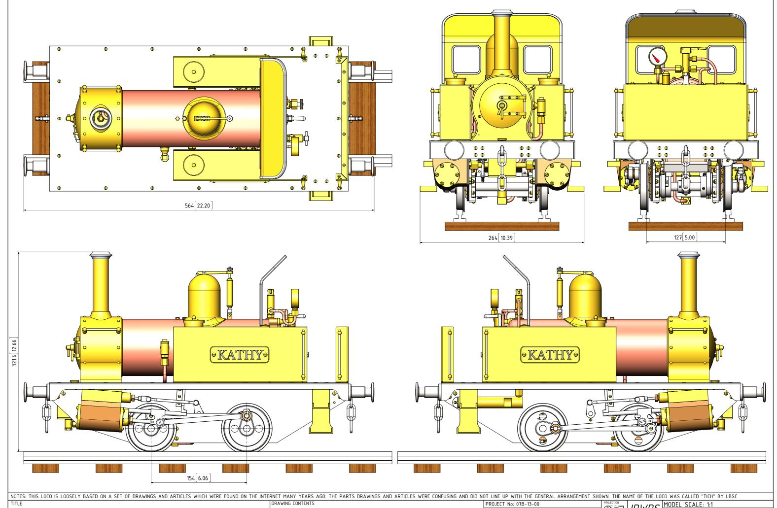
MODEL OF A 0-4-0 COAL FIRED LOCOMOTIVE CALLED "KATHY" FOR 127mm (5") GAUGE
